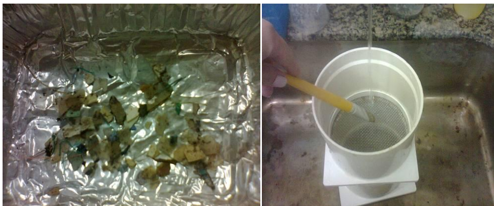
Figuras 11 e 12 - Fragmentos plásticos, a esquerda. Lavagem do material selecionado para retirada de matéria orgânica, à direita.
