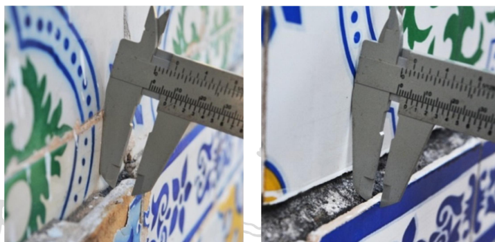
Figura 53. Azulejos com espessura de 0,8 cm, (final do século XIX), a direita e azulejos com espessura de 0,5 cm, (réplicas das décadas de 1970-80), a esquerda.
