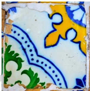
Figura 26. Bolhas – Pequena quantidade de ar (bola ou glóbulo) que se eleva à superfície do vidrado.
