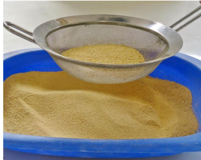
Figura 10 - Peneiramento da matéria-prima com malha de 100 mesh.
