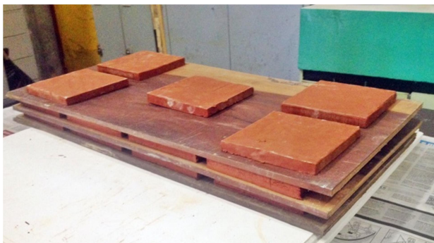
Figura 23 – Secagem das peças sobre tábuas de madeira. As peças são viradas diariamente durante o período da secagem, evitando a curvatura de suas extremidades.
