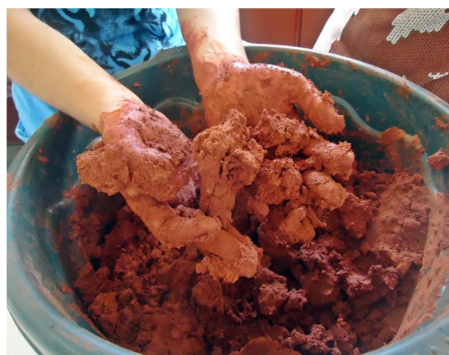
Figura 14 – Verificação do ponto de liga da mistura.
