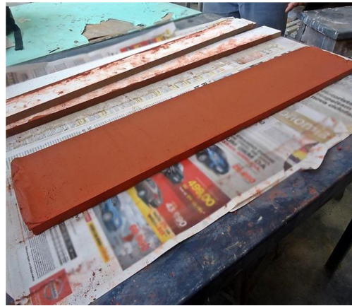
Figura 20 – Remoção das ripas de madeira, para corte das peças.
