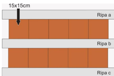
Figura 15 – Vista superior do posicionamento das ripas.
