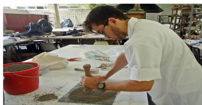
Figura 9 – Argila cinza triturada manualmente com pistilo.
