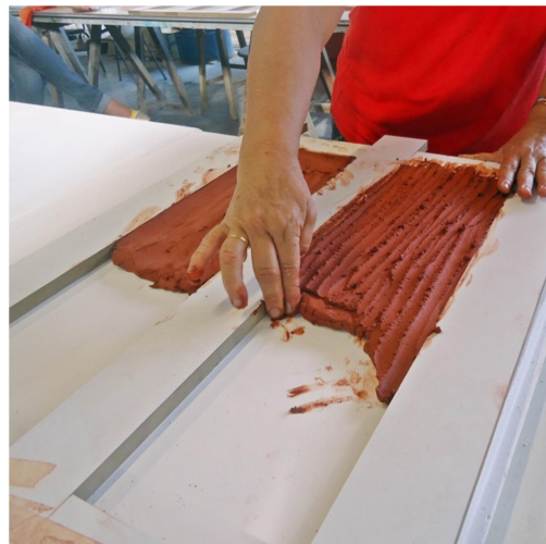
Figura 18 – O espaço é preenchido com a argila adensada, sendo colocada sobre pressão para evitar bolhas de ar.
