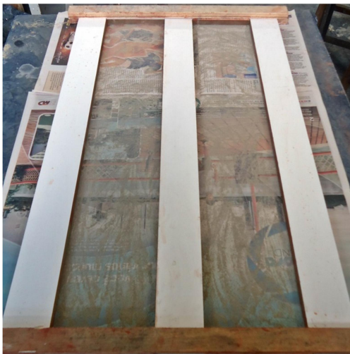
Figura 17 – Papel jornal e fina camada de areia é colocada para evitar aderência da argila na base da moldagem.
