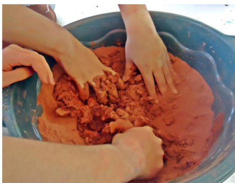
Figura 13 – Mistura manual, com adição gradual de água.
