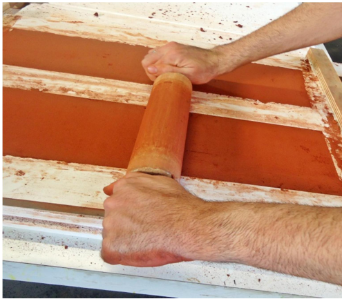
Figura 19 – Finalização com o rolo de madeira, onde as peças possuem a mesma espessura das ripas.
