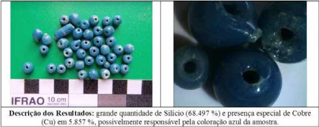
Figura 7. Conta azul representada em seu tamanho natural (esquerda) e através de imagem em estereomicroscópio (direita).
