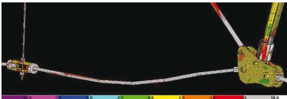
Figura 15: Deformação do tirante do banzo inferior, conforme a hipótese de cálculo H, (intervalo entre -10 e +10 Kgf/cm, deformação x 20).
