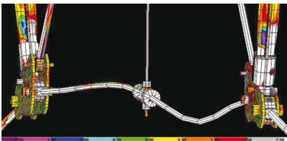
Figura 12: Deformação semelhante a que se observa nas treliças da plataforma da Estação Central, onde os tirantes do banzo inferior apresentam flambagem. (intervalo entre -2 e +2 Kgf/cm, deformação x 20).
