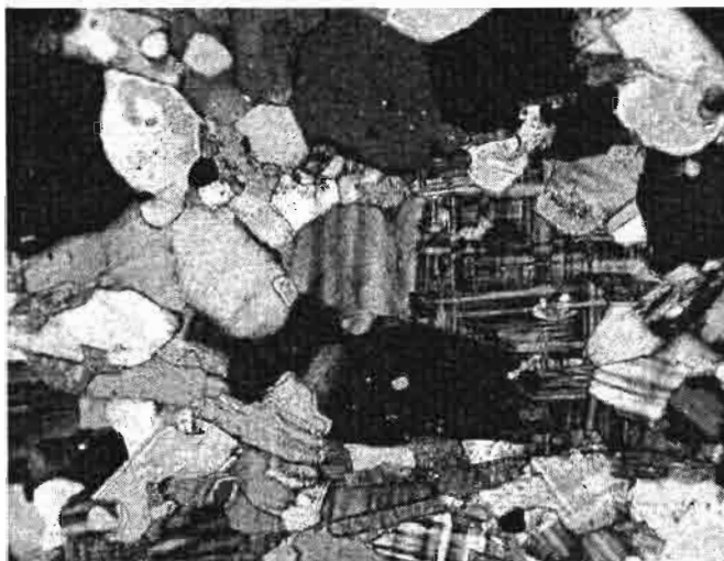
Figura 21: Composição mineralógica do quartzito Equador (quartzo, muscovita e microclina). Amostra CS52- NX - 10X.
