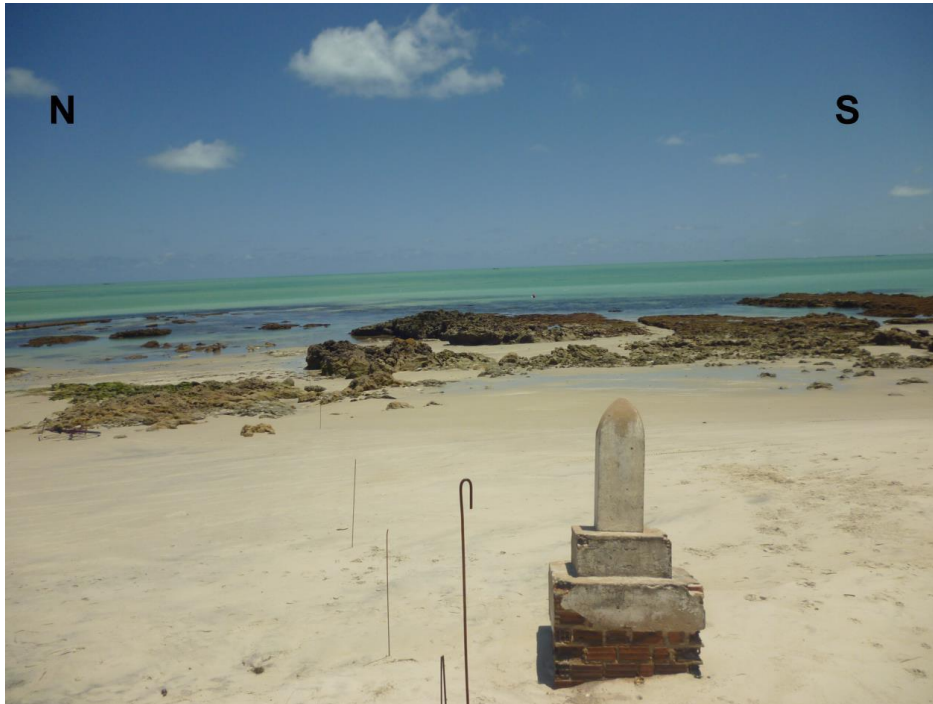
Figura 7 – Local do Perfil P4, na praia de Ponta de Pedras, durante o levantamento realizado em Março de 2015(Madruga, 2016). Na foto aparece o marco do distrito, que foi utilizado como referencia para a execução dos levantamentos neste perfil. Destaca-se a evidência do processo erosivo que causou a retirada dos sedimentos e a exposição da base do marco.
