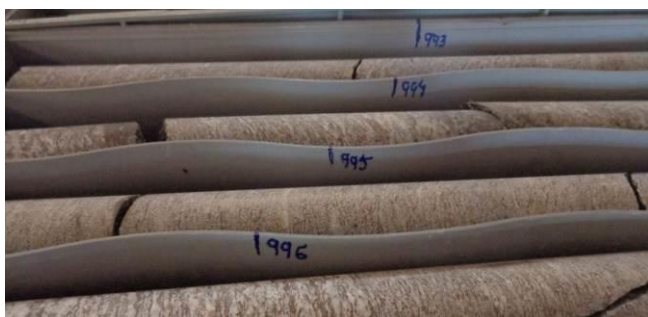
Figura 31 - Caixa de testemunho com marcação da metragem perfurada. Notar a numeração em azul nos segmentos verticais das individualizações dos testemunhos. No caso 993 a 996 metros.
