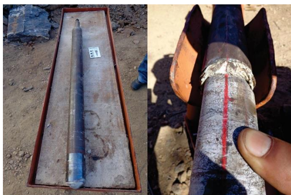
Figura 23 - Orientador com massa de modelar (lado esquerdo) e prolongamento da marcação (Az015°) no testemunho (linha em vermelho).
