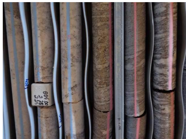
Figura 49 - Testemunhos com marcações em giz (azul ou rosa). Serragem de 1/2 ao longo da marcação para preservação do segmento a esquerda da mesma.
