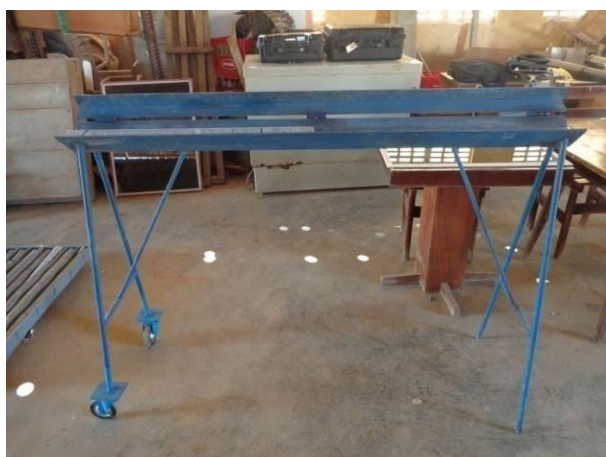
Figura 36 – Equipamento marcador de testemunhos, ressaltado em primeiro plano.
