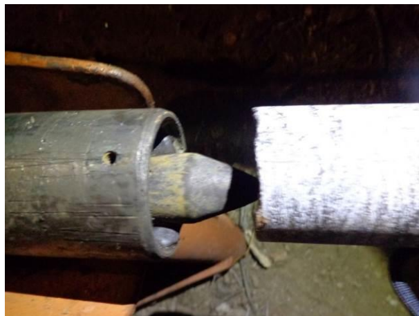
Figura 26 - Detalhe do encaixe da marcação no testemunho ao ponteiro do orientador.
