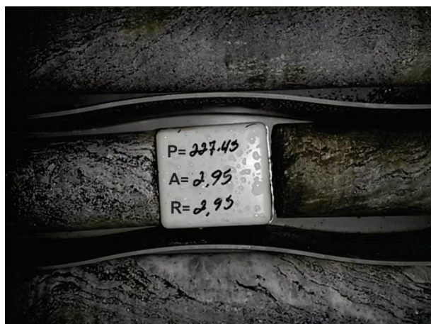
Figura 34 - Taco de uma caixa de testemunho, assinalando: profundidade (P) = 227,45m, avanço (A) = 2,95m e recuperação (R) = 2,95m.
