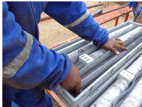
Figura 22 - Acondicionamento dos testemunhos em caixas de polietileno, com “tacos” separando os intervalos de manobra.
