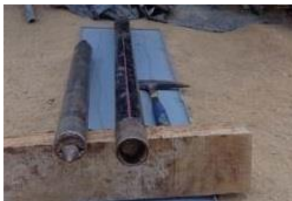
Figura 24 - Orientador com ponteiro (lado esquerdo) e de massa de modelar (lado direito).
