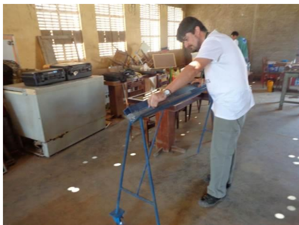
Figura 38 - Operação de complementação da marcação/orientação de testemunho.
