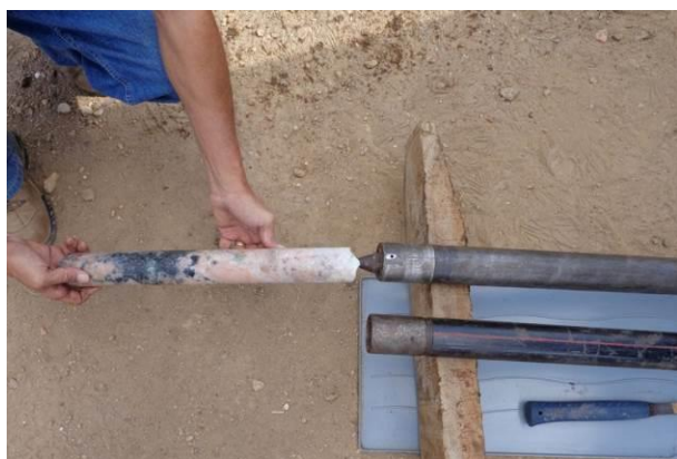
Figura 27 - Ajustando o testemunho ao orientador, para posterior marcação/orientação do testemunho.
