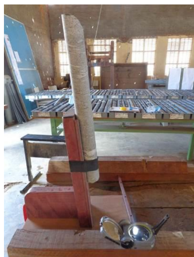
Figura 40 - Orientador de testemunho com inclinação fixa de 85^\circ , posicionado no sentido do furo executado (Az 15^\circ ).
