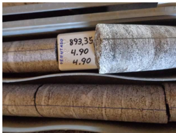
Figura 39 - Testemunhos com orientação ampliada (linha em preto).
