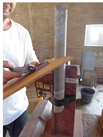
Figura 42 - Detalhe da operação de medida de plano de foliação em testemunho.
