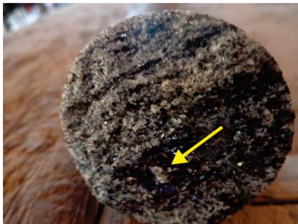
Figura 25 - Marcação do ponteiro na porção inferior da seção circular do testemunho (ponta da seta amarela).
