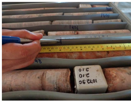
Figura 30 - Marcação da metragem perfurada (numeração em cor azul), no caso 1072 metros.
