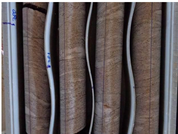
Figura 48 - Testemunhos orientados com marcações permanentes (linhas em preto). Serragem de 1/2 perpendicular a marcação para preservação da mesma.
