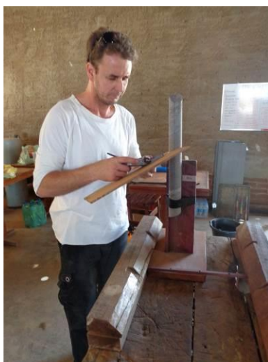
Figura 41 - Operação de medida de plano de foliação em testemunho.
