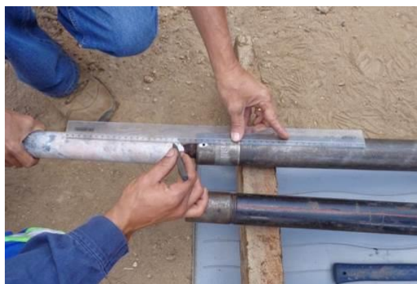
Figura 28 - Com o testemunho já ajustado ao orientador, efetua-se o prolongamento do traço/ranhura do orientador no testemunho.
