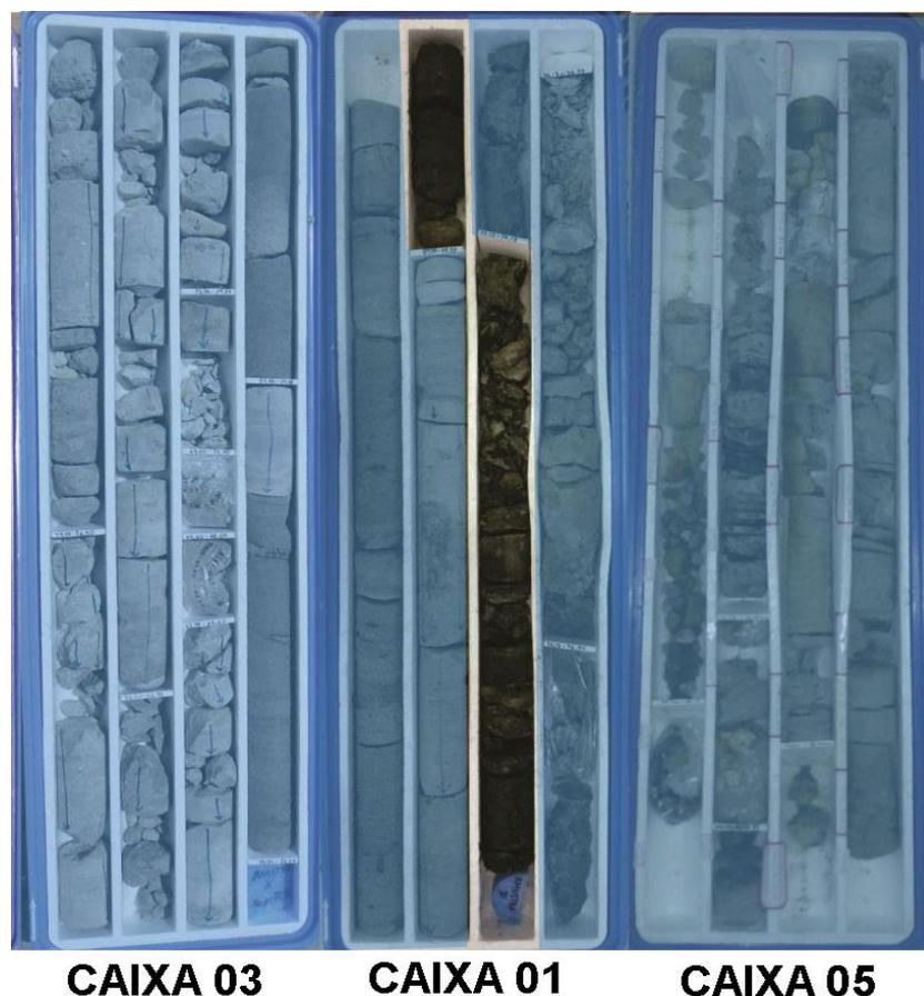
Figura 3- Caixas 03, 04 e 05 do testemunho de sondagem do poço 1-LABIO-PE3, com o folhelho negro em destaque. Caixa com comprimento 1m, testemunho com diâmetro de 45mm.
