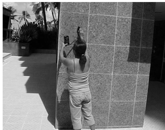
Figura 5 – medição do brilho em revestimento pétreo
