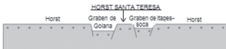
Figura 9 – Perfil C – D mostrando as estruturas em blocos (horst e grabens) sugerido na análise qualitativa do Mapa Gravimétrico Bouguer (Modificado de Silva, 2006)
