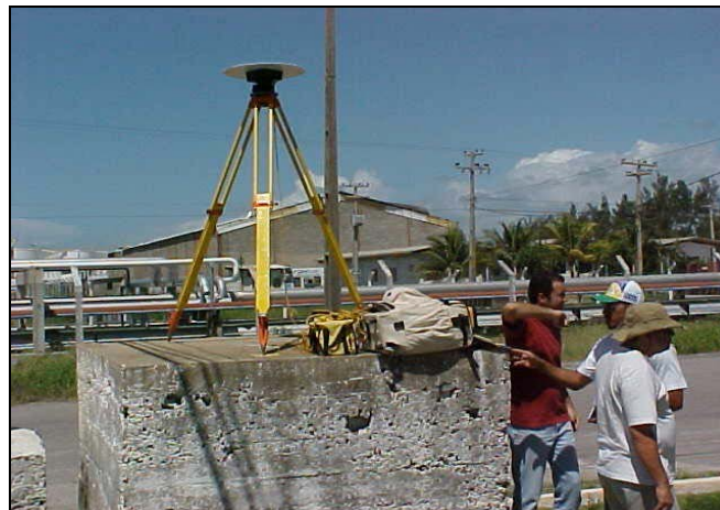
Figura 9 - Instalação do receptor 4000SST.
