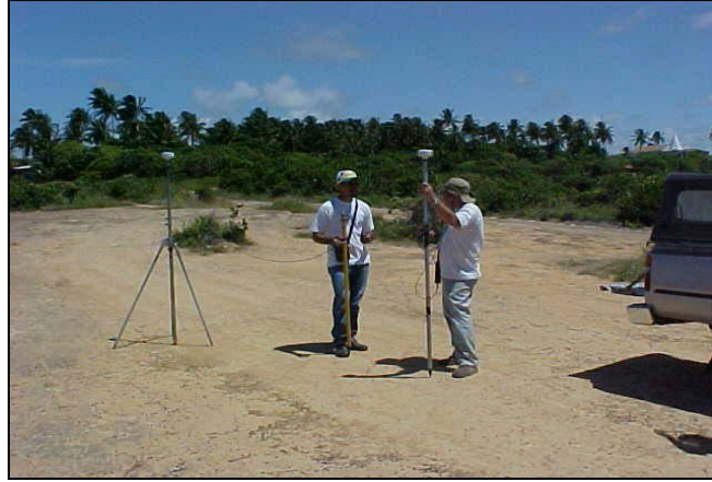
Figura 8 - Calibração de receptores GTR1.
