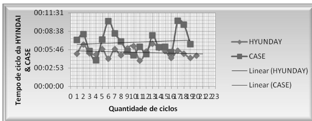
Figura 9 - Tempos de ciclo cronometrados para operação de carregamento de minério
