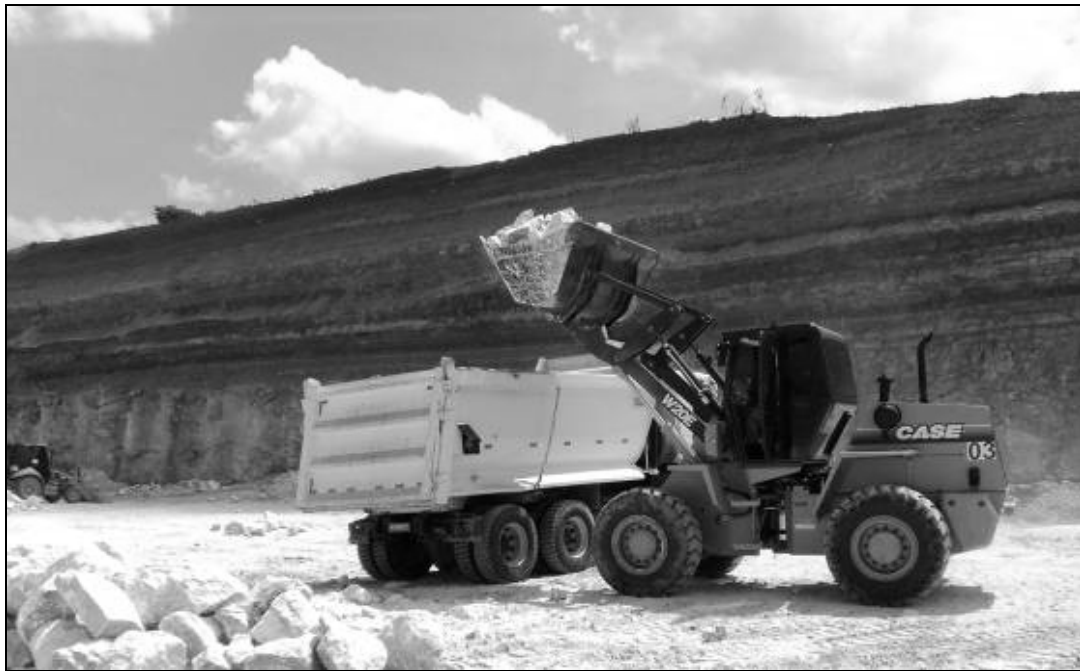
Figura 8 - Pá carregadeira de 1,7 m 3 marca CASE
