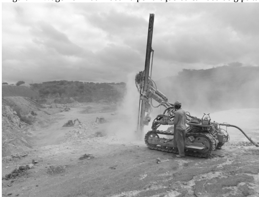
Figura 2- Rock drill utilizada na perfuração da camada de gipsita
