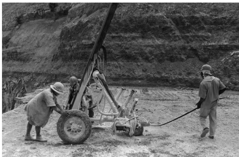
Figura 1- Wagon drill utilizada na perfuração da camada de gipsita
