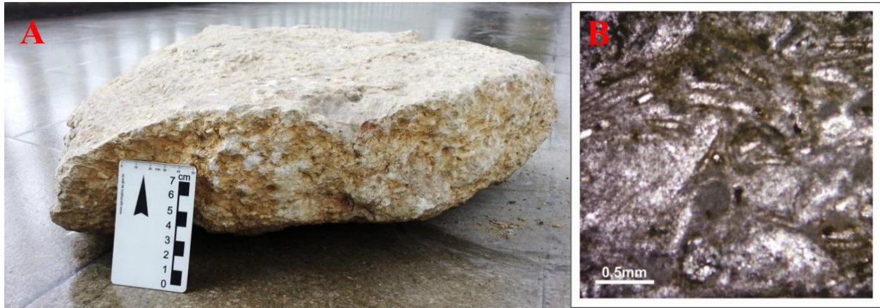
Figura 7- A- Calcário tipo coquina da Formação Romualdo, Bacia de Jatobá; B – Fotomicrografia do calcário bioclástico da Formação Romualdo, Bacia de Jatobá, mostrando carapaças preenchidas por calcita recristalizada.
