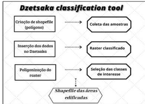
**Figura 5.** Fluxograma da classificação das imagens no plugin Dzetsaka
