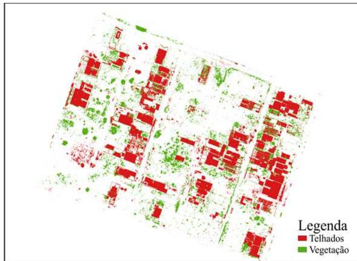
**Figura 8.** Primeira classificação dos dados PE3D utilizando *plugin Dzetsaka*, *Gaussian Mixture Model*
