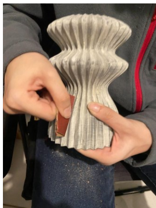
Figura 24: Processo de lixamento para acabamento superficial.
