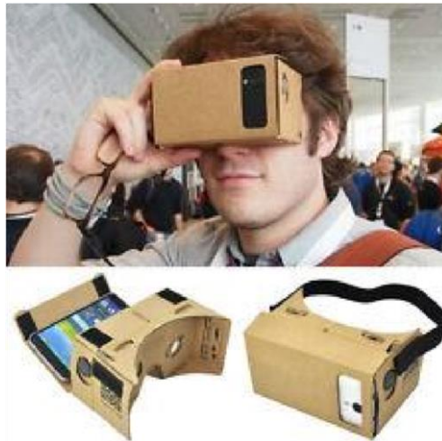
Figura 4: Óculos Google Cardboard RV – em papelão ondulado, aplicado em projeções estereoscópicas, fazendo-se uso de celulares do tipo smartphone.
