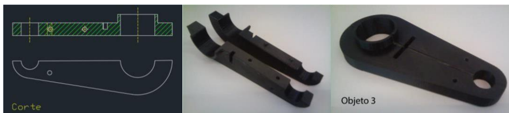
Figura 7: Detalhamento técnico e impressão 3D de material didático.
