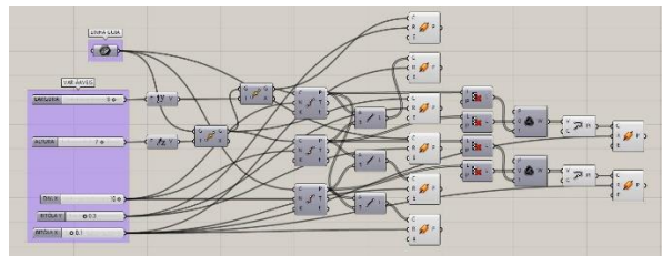
Figura 6: Algoritmo do Exercício orientado 1: treliça curvilínea parametrizada
