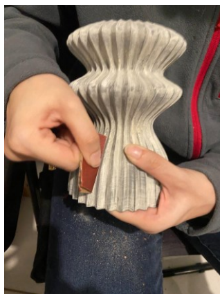
Figura 24: Processo de lixamento para acabamento superficial.
