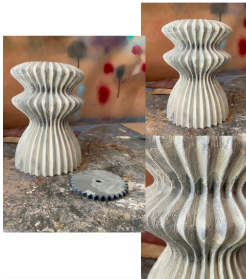
Figura 23: Montagem da luminária coberta com a massa de poliéster.
