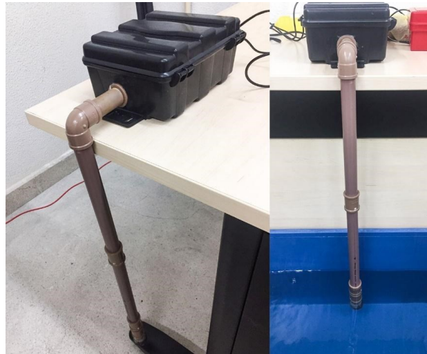
Figura 4. Aparência externa do corpo do sistema de monitoramento da turbidez da água e a sua disposição no tanque para experimentação.
