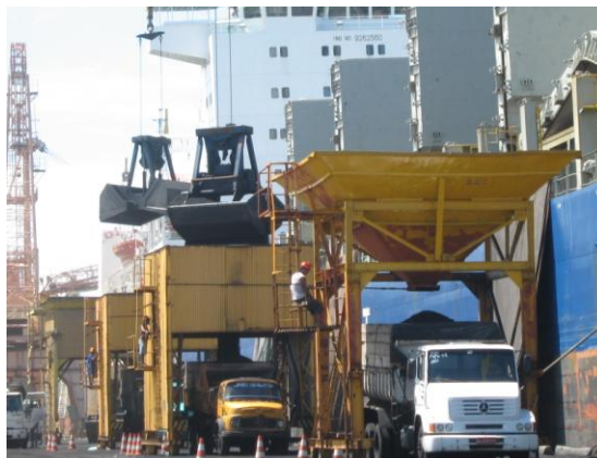
Figura 01 - Descarga do coque de petróleo: emissão de MP
