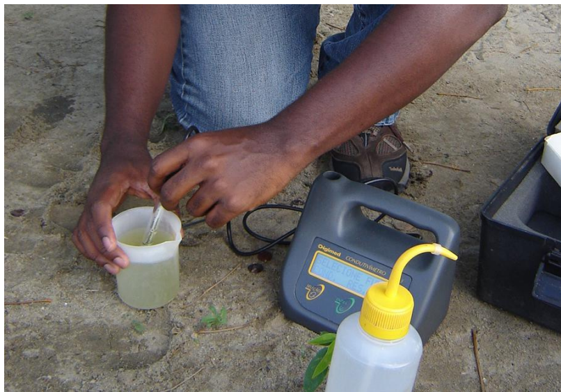
Figura 3. Análise dos parâmetros físico-químicos da água através de sonda multiparâmetro portátil.
