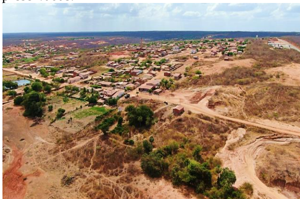
Figura 18: Crescimento urbano em borda de tabuleiro. No detalhe a declividade do terreno, incisões erosivas em meio às casas e vice-versa e planície fluvial com manchas vermelhas testemunhando o carreamento do material erodido para a calha do rio Jaguaribe, assoreando-o.
