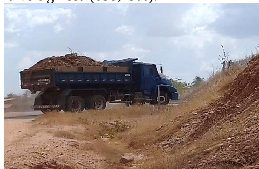
Figura 12: Transporte de piçarra usada em compactação e terraplanagem de estradas.
