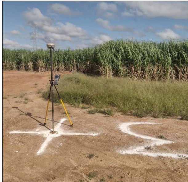
Figura 3. Levantamento geodésico com receptor GNSS do ponto de controle implantado no carreador do campo São Jorge
