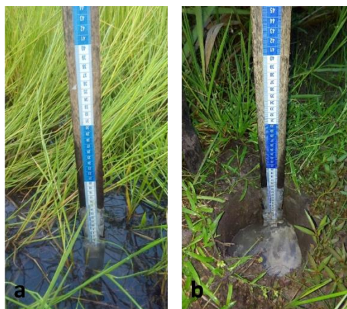
Figura 4: Medição da lâmina d'água nos pontos onde a mesma estava aparente (acima da superfície do solo) (a) e nos pontos onde não estava aparente (abaixo da superfície do solo), com abertura de cova (b).
