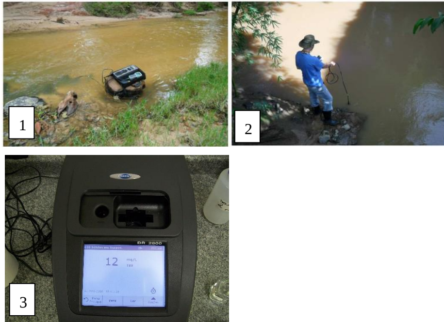
Figura 4 – Amostragem analítica dos parâmetros físico-químicos junto à foz das bacias hidrográficas estudadas (1- ribeirão Monjolo Grande e 2 – ribeirão Jacutinga) e utilização do Espectrofotômetro para quantificação dos Sólidos Totais em Suspensão (3). Fonte: Elaborado pelos autores.
