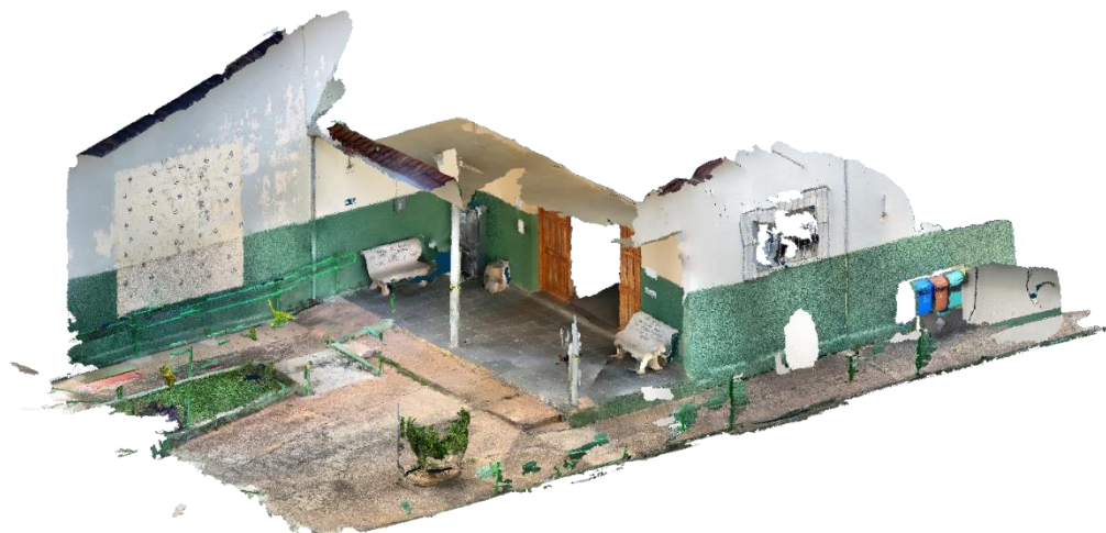
Figura 4. Nuvem de pontos resultante de varredura com Iphone PRO 13 Max
