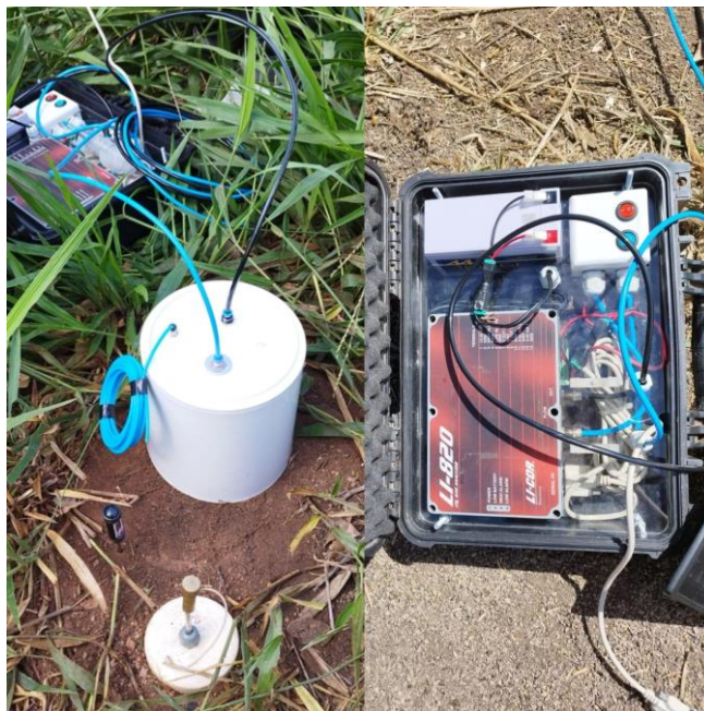
Figura 4. Câmara com fluxo dinâmico e analisador de gás por infravermelho (LICOR, LI-820).
