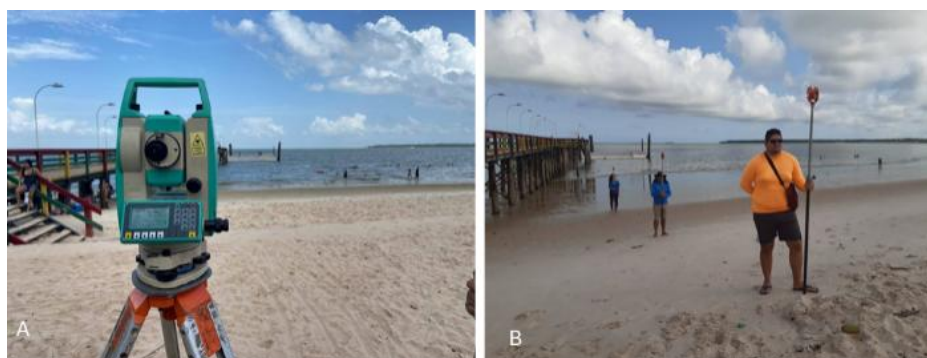
Figura 4. Equipamento utilizado para o levantamento topográfico: Estação Total, modelo RUIDE RTS-822R 3 (A). Posicionamento dos três prismas para leitura dos dados pela Estação Total (B). Fonte: Registro feito pelos autores.
