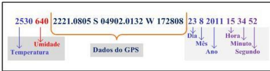
**Figura 3.** Estrutura do registro de dados gerado pelo *software*, com os dados do dispositivo de sensoriamento e do GPS. As informações do registro incluem os dados físicos medidos (temperatura e umidade), a localização do ponto de medição, a data e horário da medição.
