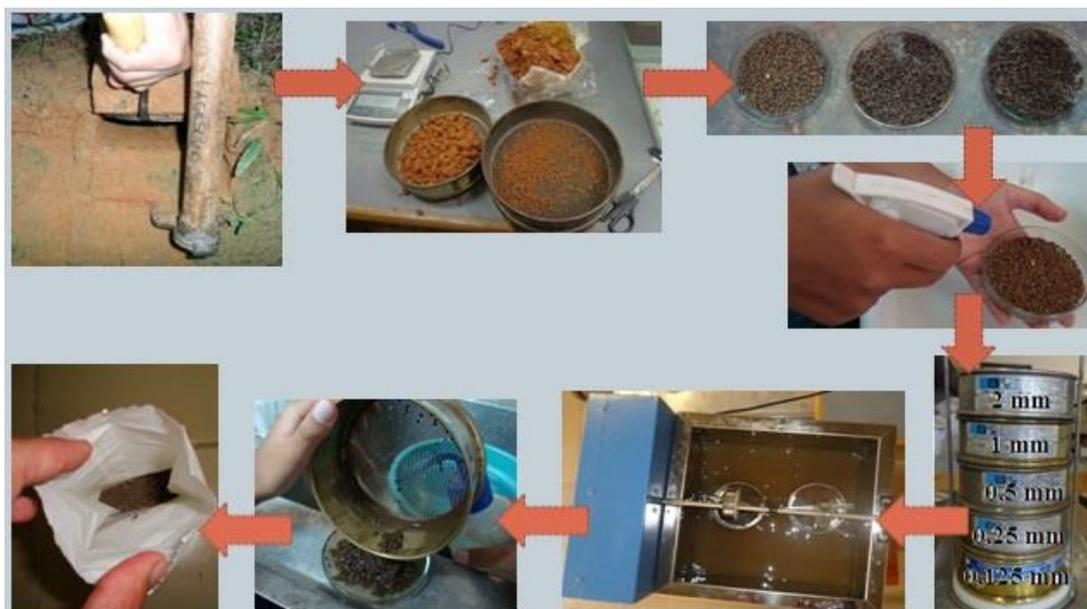
**Figura2.** Procedimento para determinação da estabilidade de agregados em água. Fotos: L. A. Rangel, 2012
