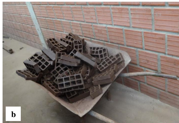
Figura 3. a) Máquina de corte e b) Pedacos de cerâmica advindos da etapa de corte
