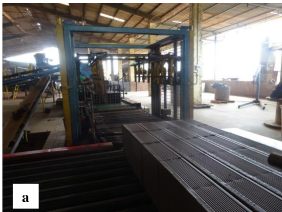
Figura 3. a) Máquina de corte e b) Pedacos de cerâmica advindos da etapa de corte
