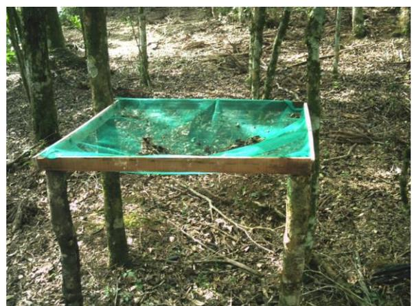
**Figura 3-** Coletor de serrapilheira instalado no plantio de erva mate.
