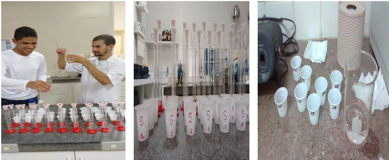
Figura 7. Medição de volume, provetas após adição dos reagentes e copinhos plásticos com as amostras de amônia encaminhados a leitura em espectrofotômetro.
