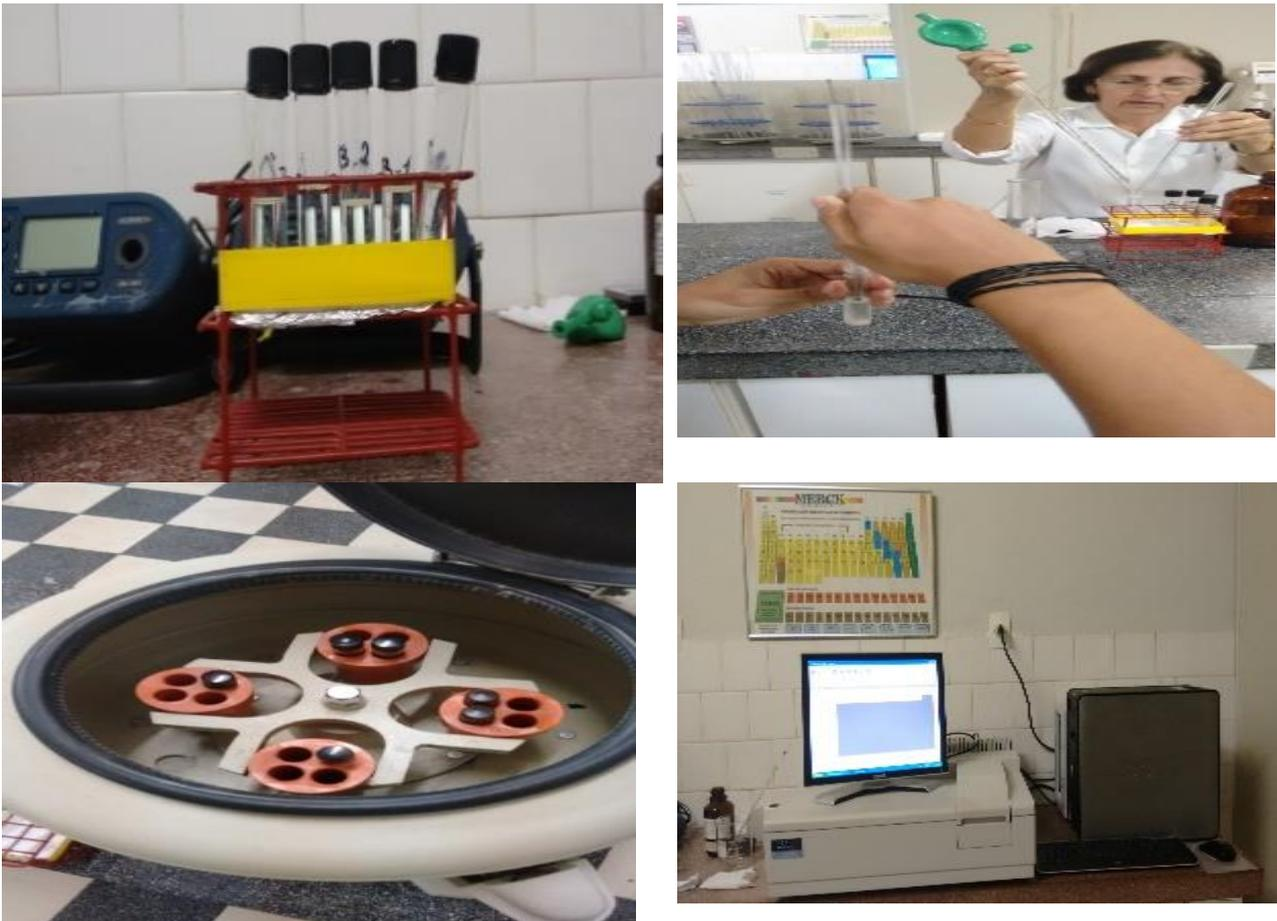
Figura 5. Material fitoplânctônico em tubos de ensaio, adição de acetona 90% e maceração de amostra filtrante, agitação em centrífuga e espectrofotômetro utilizado em análise.
