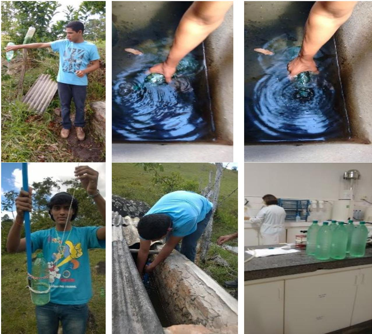
Figura 4. Despejo de água *in natura*, coletas de água na superfície e meio das nascentes, coletas no fundo com armação de improviso e amostras de água coletadas em laboratório.
