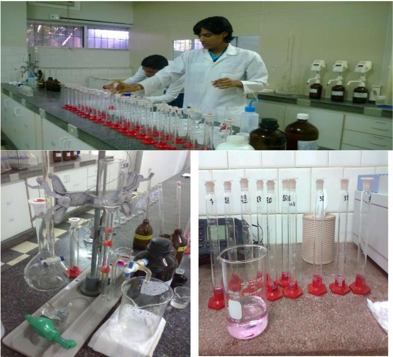
Figura 6. Medição de amostras de água em provetas, ativação da coluna em bureta, solução rosada de nitrato obtida após titulação e provetas de nitrito e nitrato em sala espectrofotométrica.
