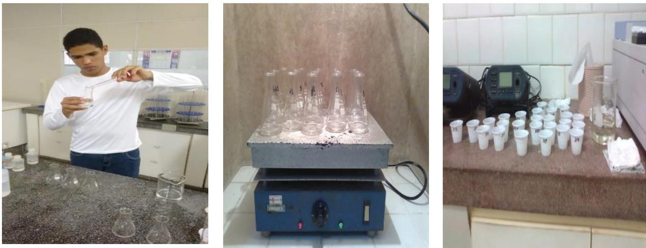
Figura 8. Medição do volume em erlenmeyers, digestação de fosfato em capela e copinhos plásticos contendo as amostras em sala de espectrofotometria.
