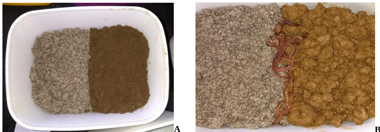
Figura 2. Aspecto do bioensaio de fuga com minhocas da espécie Eisenia andrei : montagem do sistema (A); e sistema com minhocas recém-introduzidas (B). Nota: o material de cor acinzentada corresponde ao solo artificial.
