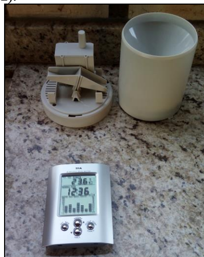
Figura 2 – Pluviômetro digital utilizado para monitoramento da precipitação. Fonte: Foto dos autores (2017)
