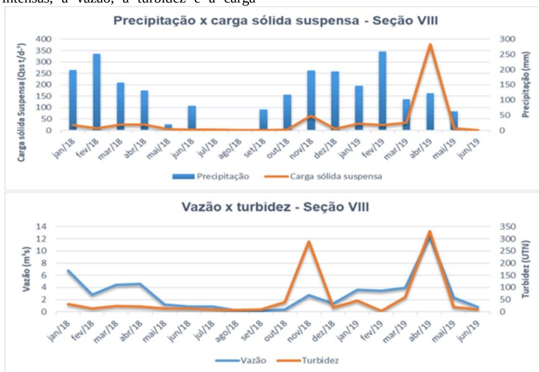
Figura 17 – Precipitação, vazão, turbidez e carga sólida suspensa na seção VIII, no córrego Corgão, próximo a confluência com o rio Branco, na BHRB, Mato Grosso
