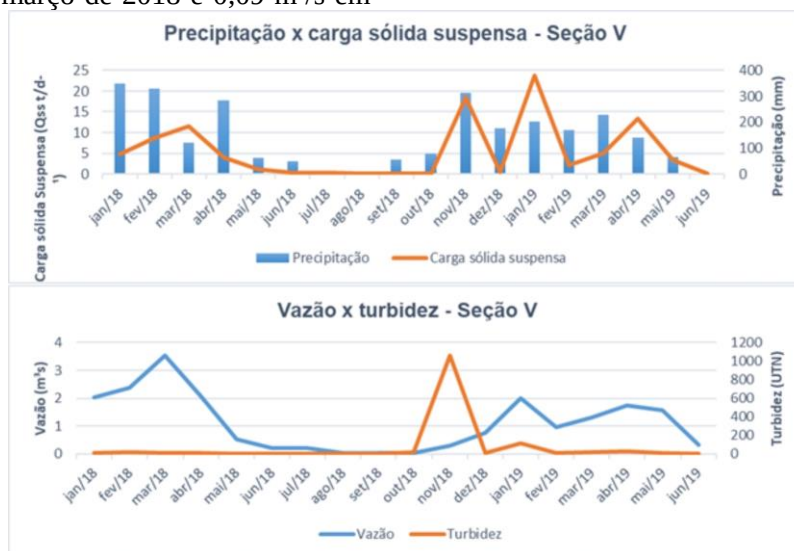
Figura 14 – Precipitação, vazão, turbidez e carga sólida suspensa na seção V, no córrego das Pedras, próximo a confluência com o rio Branco, na BHRB, Mato Grosso
