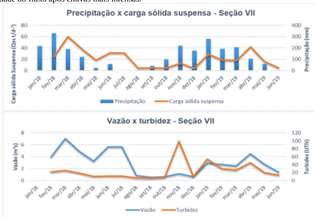
Figura 16– Precipitação, vazão, turbidez e carga sólida suspensa na seção VII, no córrego do Pito nas proximidades da confluência com o rio Branco, na BHRB, Mato Grosso
