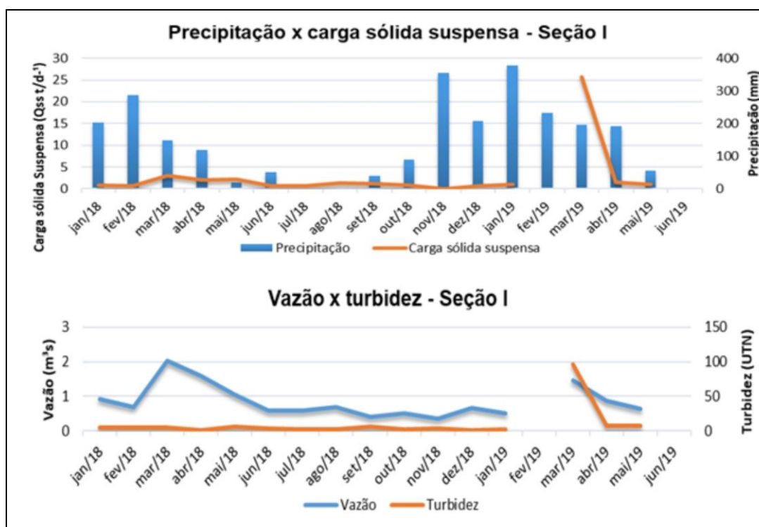
Figura 8 – Precipitação, vazão, turbidez e carga sólida suspensa na seção I, no córrego Grande na BHRB, Mato Grosso
