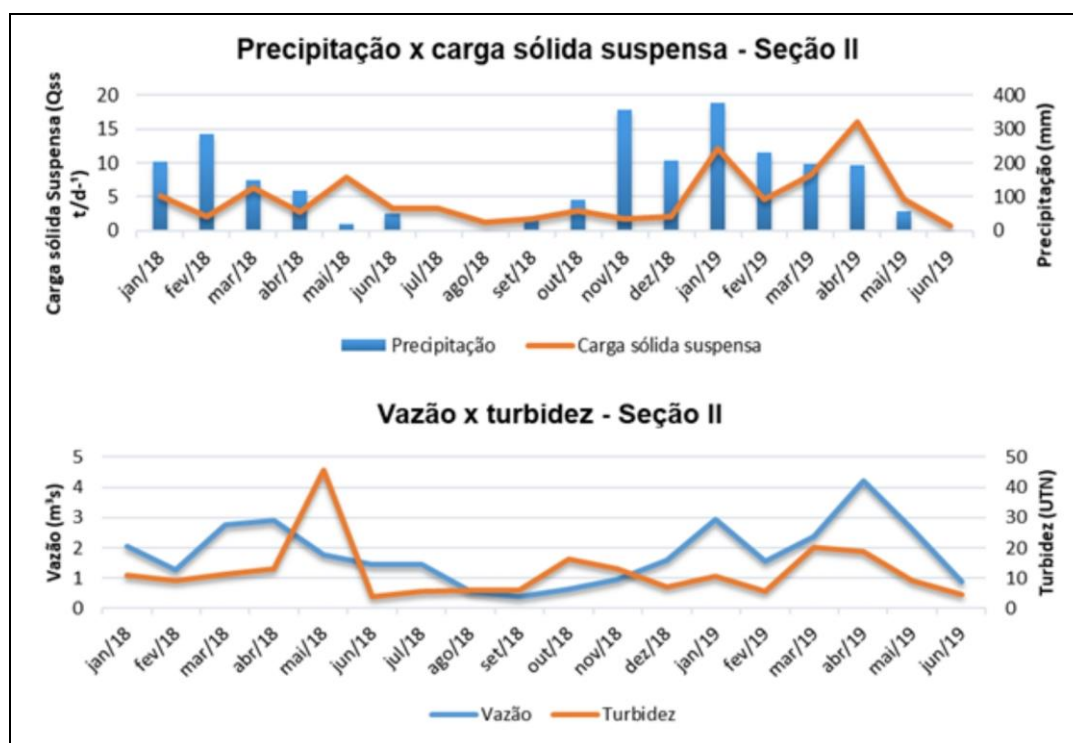
Figura 9 – Precipitação, vazão, turbidez e carga sólida suspensa na seção II, no córrego Santa Virgínia na BHRB, Mato Grosso
