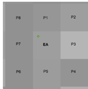
Figura 3. Ilustração de análise de resposta espectral por meio dos valores registrados nos pixels.
