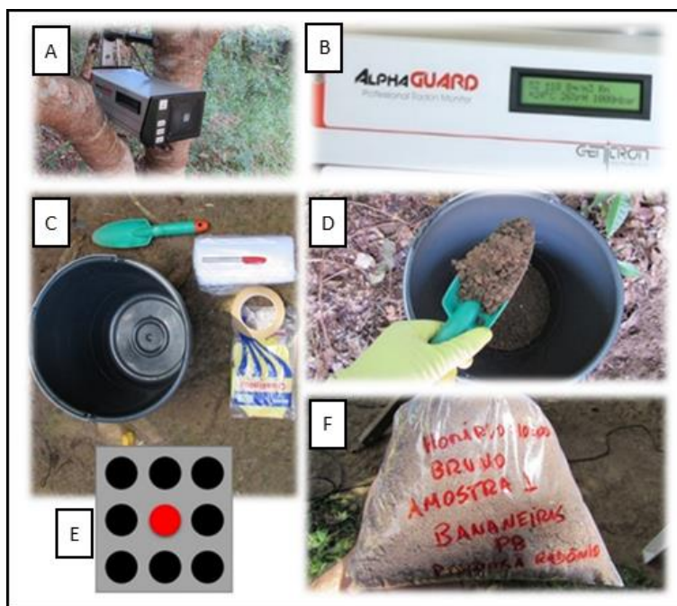
Figura 5 – A) Local de medição do Radônio em Bananeiras/PB, com o equipamento fixo em uma árvore a altura de 1 m do chão. B) Detalhes do equipamento utilizado. C) Material Utilizado para coleta de solo. D) Recipiente de armazenamento e mistura para obtenção da amostra composta. E) Esquema de quadrantes utilizado para definir os locais de coleta de sub amostras de solo e/ou rocha; o círculo vermelho representa a posição do equipamento de medição da concentração do Radônio; os círculos pretos, equidistantes de um metro, correspondem aos locais de coleta de sub amostras de solo e/ou rocha. F) Amostra de solo armazenada e identificada.
