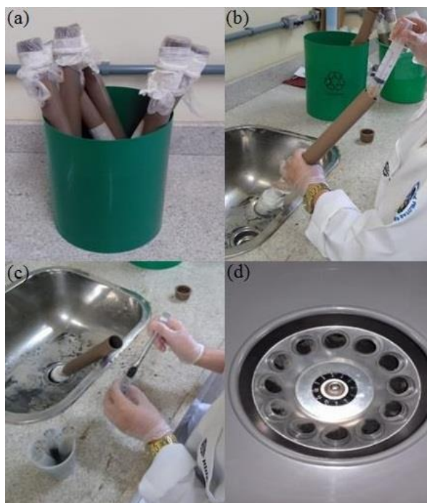
Figura 2. Metodologias aplicadas para extração de água intersticial: (a) etapa de decantação, (b) extração inicial de água, (c) retirada da amostra (água-sedimento) homogeneizada, (d) centrifugação das amostras homogeneas.
