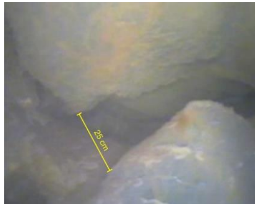
Figura 5. Exemplo de imagem obtida a partir da videoinspeção de poço profundo (SS-01), perfurado no sistema físsuro-cárstico localizado na região de São Sebastião, Distrito Federal, Brasil. A cavidade de dissolução tem uma abertura máxima de 25 cm a 96 m de profundidade (Souza, 2013).
