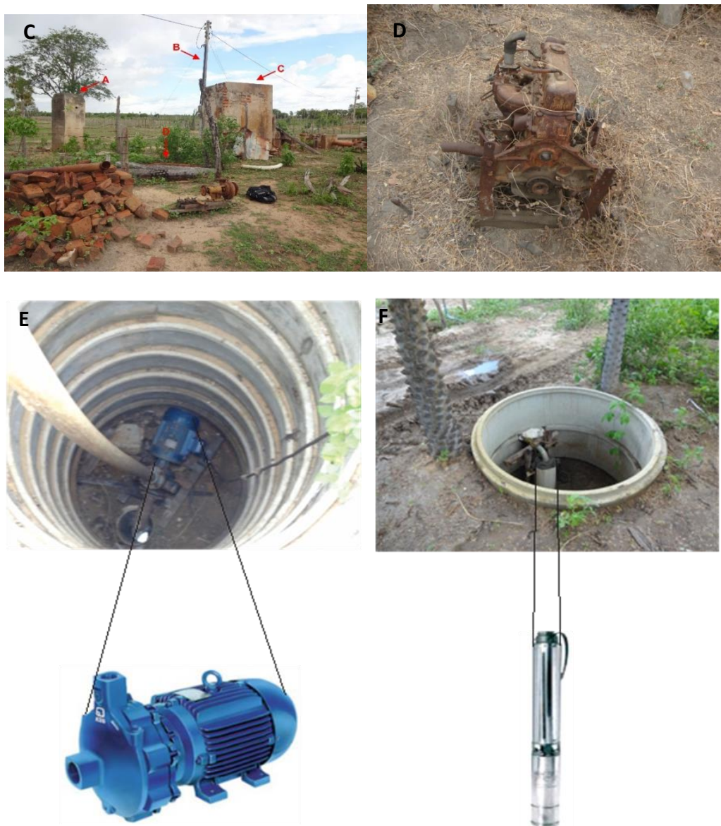
Figura 6. Modelos utilizados na irrigação. A) Cata-vento com estrutura de madeira; B) Cata-vento com estrutura metálica; C) Resquíio de estrutura para gasogênio; D) Motor gasogênio; E) Motor elétrico; F) Bomba de captação d'água de sistema elétrico.
