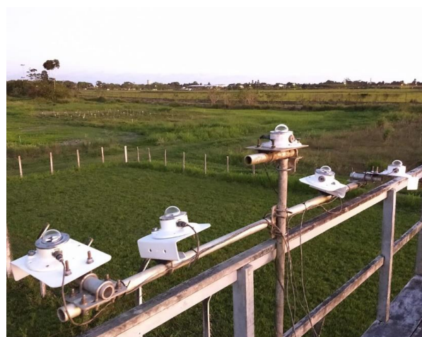
Figura 2. Piranômetros (Eppley modelo 8- 48, B&W) instalados nos planos Leste, Oeste, Norte e Sul inclinados à 10° e no plano horizontal.
