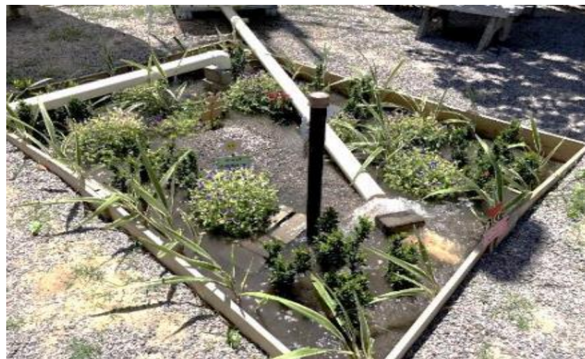
Figura 4 – Simulação de chuva em execução. As águas pluviais simuladas são conduzidas da área de captação para o jardim através da tubulação. Fonte: Autores.
