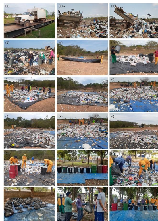
Figura 2. Ensaio gravimétrico em Itacoatiara. (a) Pesagem dos veículos de coleta; (b) Local de descarregamento do caminhão; (c) Descarregamento do caminhão; (d) Coleta da amostra em pontos aleatórios da pilha; (e) Recobrimento do solo; (f) Recebimento das amostras na lona; (g) Rompimento dos sacos e homogeneização da amostra de 11.000 litros; (h) 1º quarteamento da amostra homogeneizada; (i) Obtenção da amostra de 5.500 litros e homogeneização; (j) 2º quarteamento da amostra homogeneizada; (k) Obtenção da amostra de 2.700 litros e homogeneização; (l) 3º quarteamento da amostra homogeneizada; (m) Coleta da amostra final de 1.375 litros; (n) Tambores com as amostras; (o) Segregação da amostra final; (p) Amostra segregada por classe; (q) Pesagem das amostras segregadas e tabulação dos dados; e (r) Equipe operacional.
