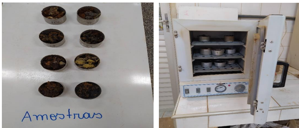
Figura 4 - Determinação do teor de umidade dos resíduos
