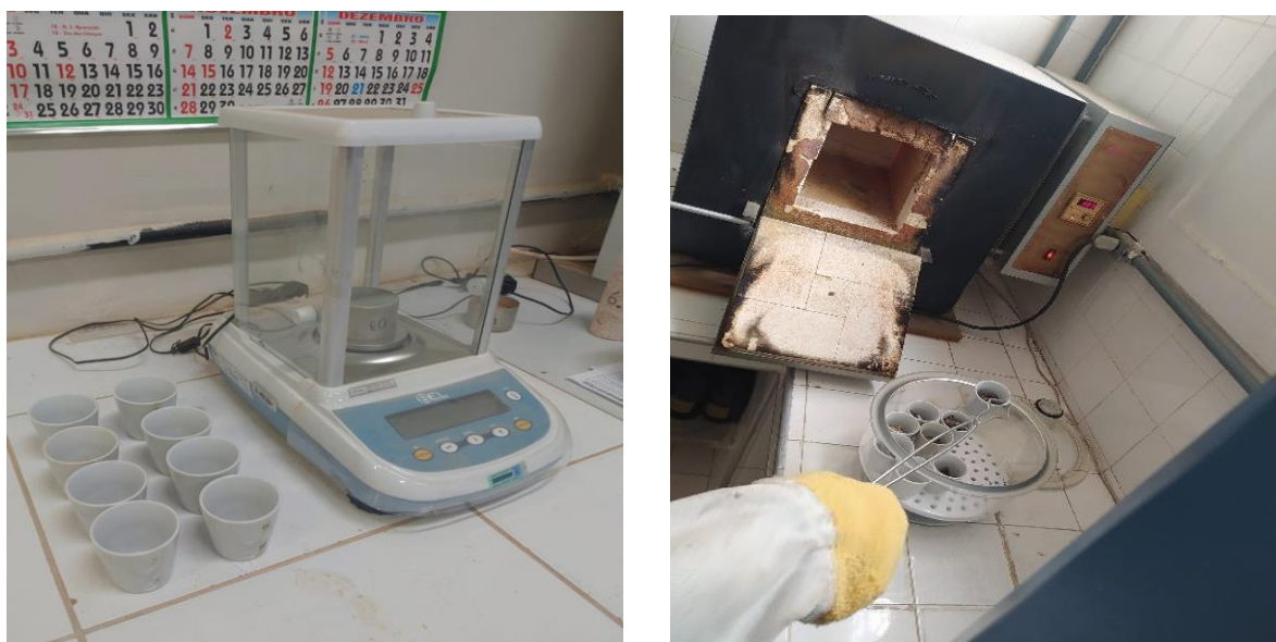
Figura 5 - Determinação do teor de sólidos voláteis dos resíduos
