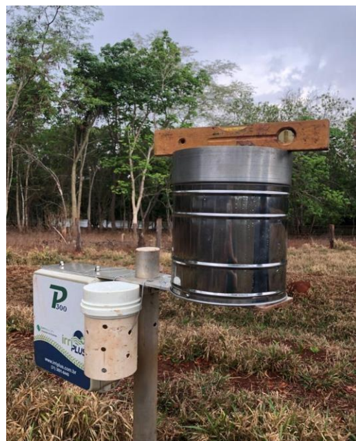
Figura 7. Nivelamento do equipamento.
