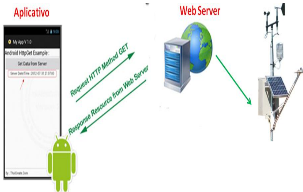
Figura 1. Diagrama de requisição dos dados para processamento pelo aplicativo.
