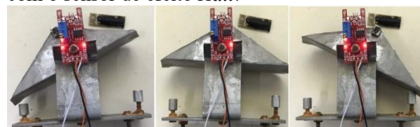
Figura 6 - Funcionamento das balsas com o sensor de efeito Hall.
