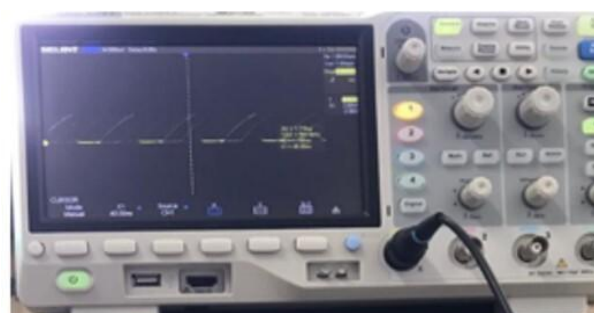
Figura 4 - Sinal gerado pela interação do módulo Hall KY-024 com o Módulo T-A7670E no osciloscópio.
