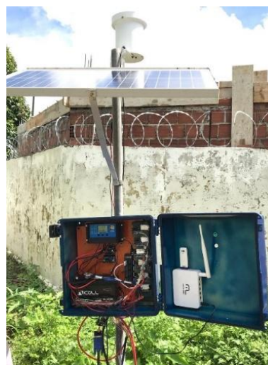
Figura 11 – Equipamento de medição de chuvas instalado em Nova Descoberta – Recife.
