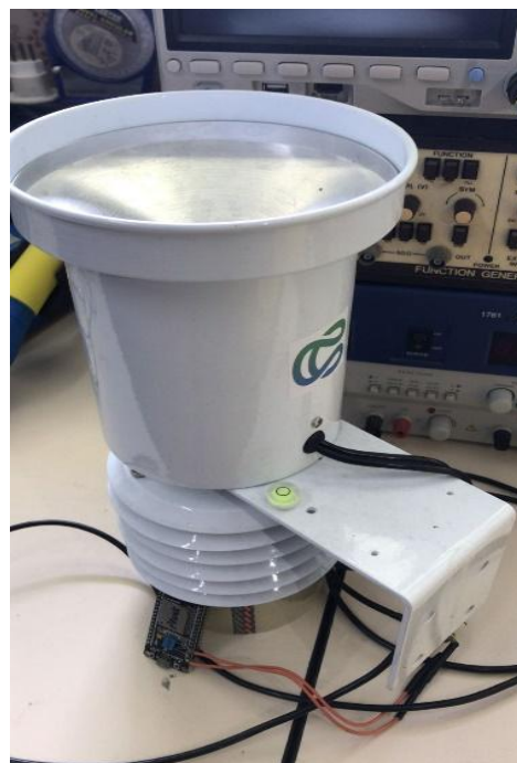
Figura 1 - Pluviômetro balsa modelo PL-1 utilizado no equipamento.
