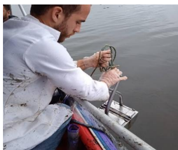
Figura 3 – Uso da draga Van Veen para coleta dos sedimentos superficiais do fundo.
