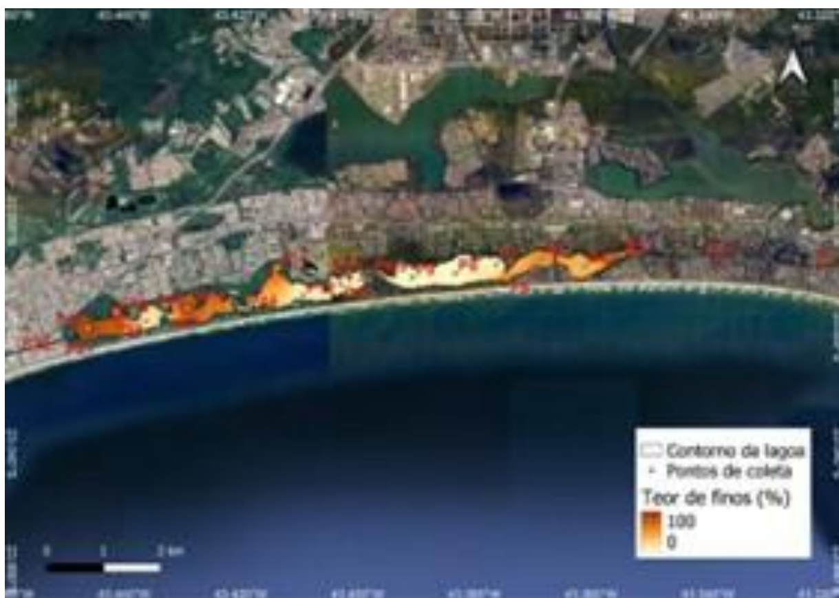
Figura 5 – Distribuição espacial da lama (silte + argila) nos sedimentos de fundo da Lagoa de Marapendi (Complexo Lagunar de Jacarepaguá – Rio de Janeiro, RJ).
