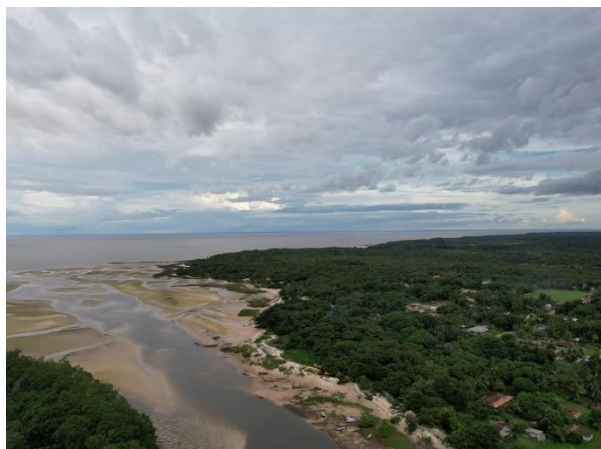
Figura 8 – Delta de vazante formado na desembocadura do Canal do Jubim com o estuário do Rio Pará, devido ao efeito de “molhe hidráulico” do rio.
